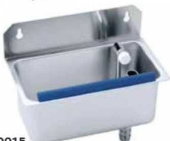
5820015 Anbauspüle 15 Edelstahl 18/10, mit regelbarem Wasserzulauf, Zulauf für Ø 8mm Quetschverschraubung, Ablauf für 3/4" Schlauch l 22,0 x b 12,3 x h 9,0 cm 1 Stk. 85,00 €
